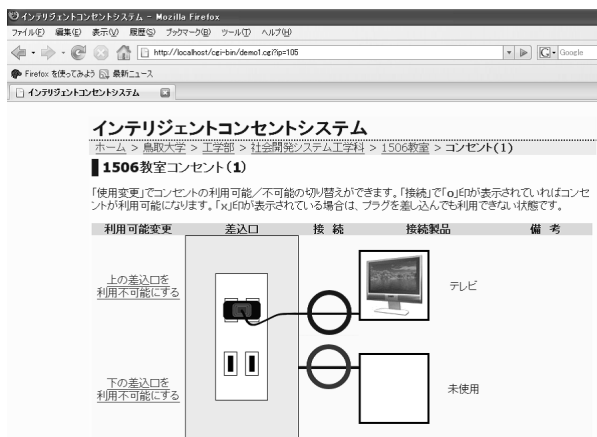
図 8: リレーが ON の状態でテレビが接続されている時の実行画面
